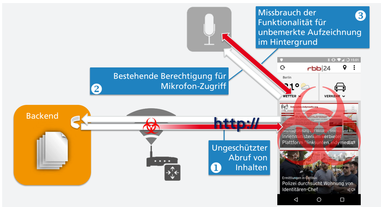
Abbildung 2: Unautorisierter Zugriff auf das Mikrofon: Fehlender Integritätsschutz stellt eine große Gefahr für Hybrid-Apps dar, wenn die App Berechtigungen für den Zugriff auf kritische Ressourcen wie Mikrofon oder Dateisystem hat. Hier dargestellt am Fall der rbb24-App für iOS und Android in Version 1.7.1.
