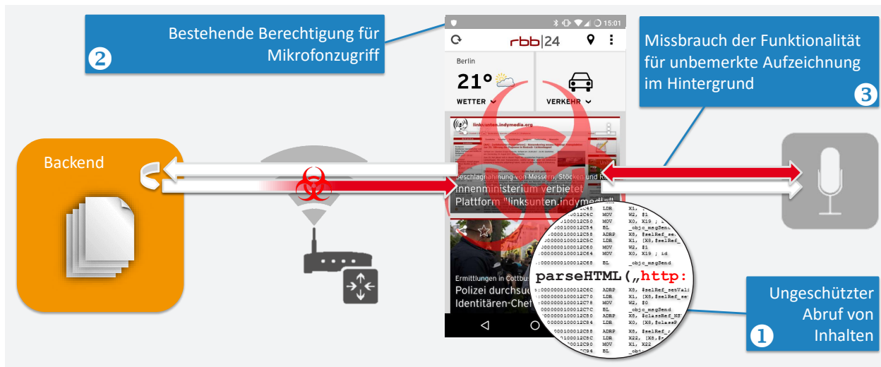
Abbildung 3: Funktionsmissbrauch: Fehlender Integritätsschutz stellt eine große Gefahr für Hybrid-Apps dar, wenn die App Berechtigungen für den Zugriff auf kritische Ressourcen wie Mikrofon oder Dateisystem haben. Hier dargestellt am Fall der rbbj24 App für iOS und Android (Version 1.7.1.)
