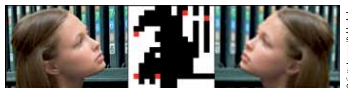
Die robusten Hashs dieser Bilder unterscheiden sich in nur fünf Bits. Das Verfahren zeigt deshalb an, dass diese Bilder identisch sind.
